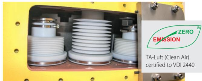
ゼロエミッション設計により、ポンプで運ばれた媒体が周囲の空気から密閉されていることが保証され、環境を脅かす毒性のある爆発性の流体を最大4000 barで安全に汲み出すことができます。
