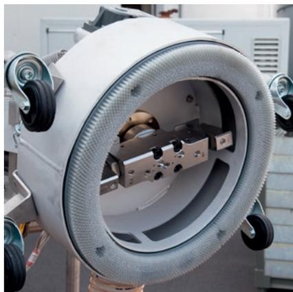
Oszillierende Bewegungen zur optimalen Behandlung von punktuellen Schäden. Der vollständig abgeschirmte Strahlbereich gewährleistet hohe Arbeitssicherheit und dank integrierter Absaugung von Abwasser umweltfreundliches Arbeiten.
